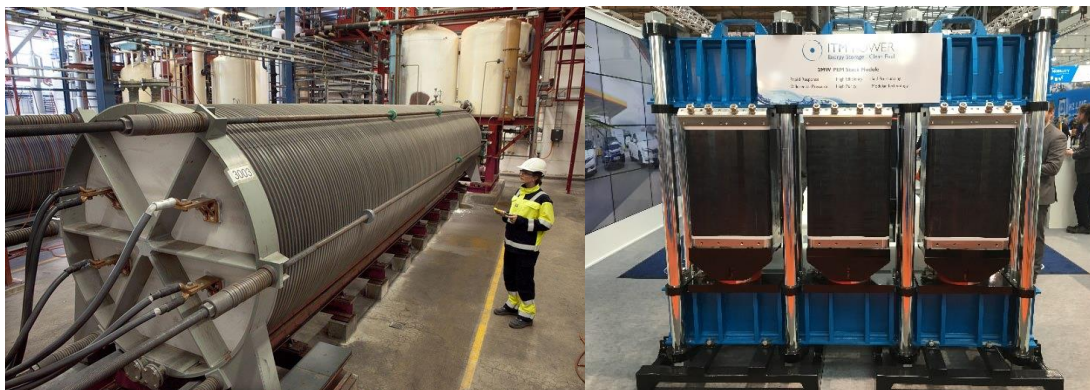
Figuur 2: een 2 MW alkaline waterelektrolyzer (links) en een 2 MW PEM water elektrolyzer (rechts)
